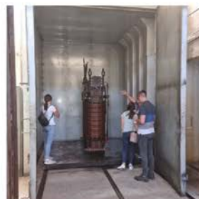
Peć za sušenje zapremine 36 m 3
